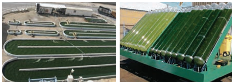
شکل ۱۷- دو نوع فتوبیوراکتور که در آن جلبک تک یاخته‌ای کشت شده است.
