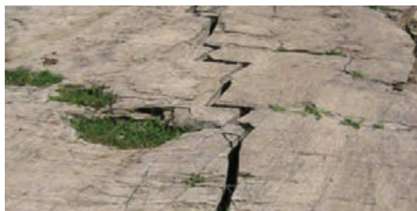
(ب) رفتار شکننده سنگ‌ها
