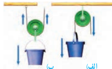
شکل ۱۲ - قرقره ثابت و قرقره متحرک
