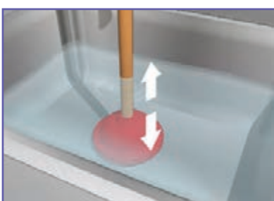
ب – حرکت عمودی لوله بازکن
