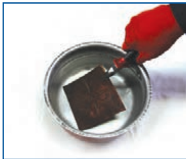
شکل ۹-۱۱- سرد کردن پلاک مسی با آب
