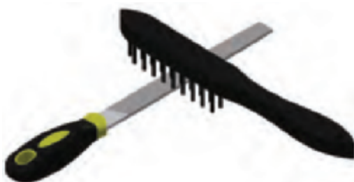
شکل ۱۷-۵. تمیز کردن سوهان با برس سیمی
