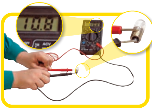
شکل ۸- اندازه‌گیری مقاومت لامپ خاموش با اهم سنج
