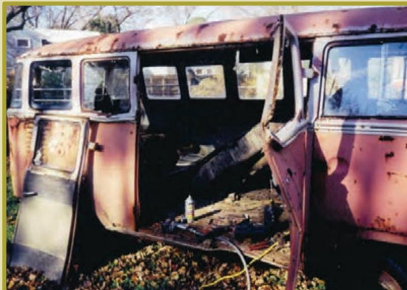
آهن فلزی است که وقتی در جای مرطوب قرار می‌گیرد، به رنگ قهوه‌ای در می‌آید و پوسته پوسته می‌شود. یعنی کم کم به ماده‌ی جدیدی تبدیل می‌شود که زنگ آهن نام دارد. فلزهایی مانند طلا، آلومینیوم و مس به این دلیل برّاق باقی می‌مانند که زنگ نمی‌زند. زنگ زدن وسایل آهنی یا فولادی، باعث فرسودگی و سست شدن آن‌ها می‌شود. یکی از راه‌های جلوگیری از زنگ زدن آهن، پوشاندن سطح آن به وسیله‌ی رنگ است.
