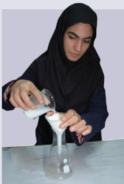
برای جدا کردن ذرات ریز جامد در مخلوطی که به شکل مایع است، مانند مخلوط نشاسته و آب، از صافی‌هایی که روزنه‌های آن بسیار ریز است (صافی‌های پارچه‌ای و کاغذ صافی) استفاده می‌کنیم.
