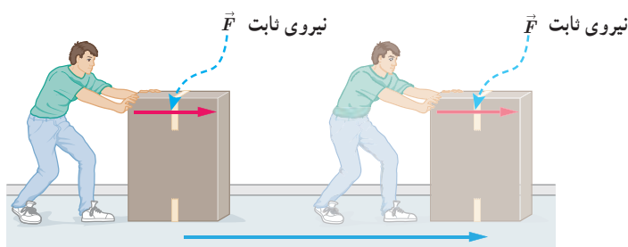
شکل ۲-۳ نیروی ثابت \vec{F} که با جابه‌جایی \vec{d} هم جهت است، کار W = Fd را انجام می‌دهد.
