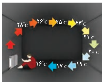
شکل ۴-۲۸ گرم شدن هوای اتاق به روش همرفت
