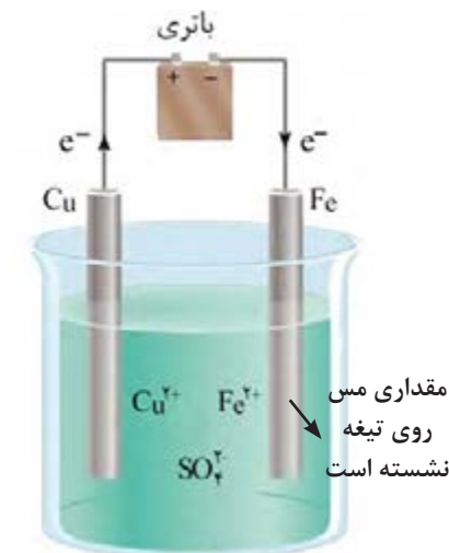
شکل ۶. سلول الکتروشیمیایی مس - آهن
