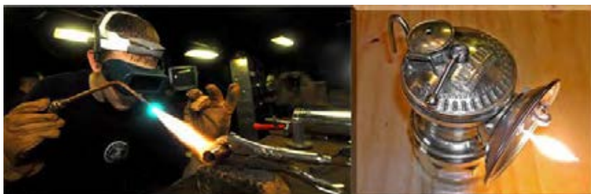
شکل ۷. استفاده از گاز اتین (استیلن) در برشکاری فلزات و لامپ‌های کاربرد.
