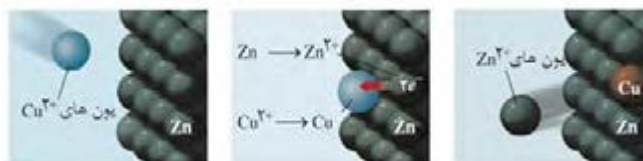
شکل ۳. چگونگی انتقال الکترون از اتم‌های روی به یون‌های مس
