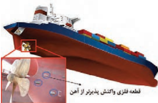
شکل ۱۲. چگونگی حفاظت کاتدی بدنه کشتی
