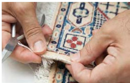
▲ تصویر ۴۵ - تنظیم کشش نخ هنگام دوخت
