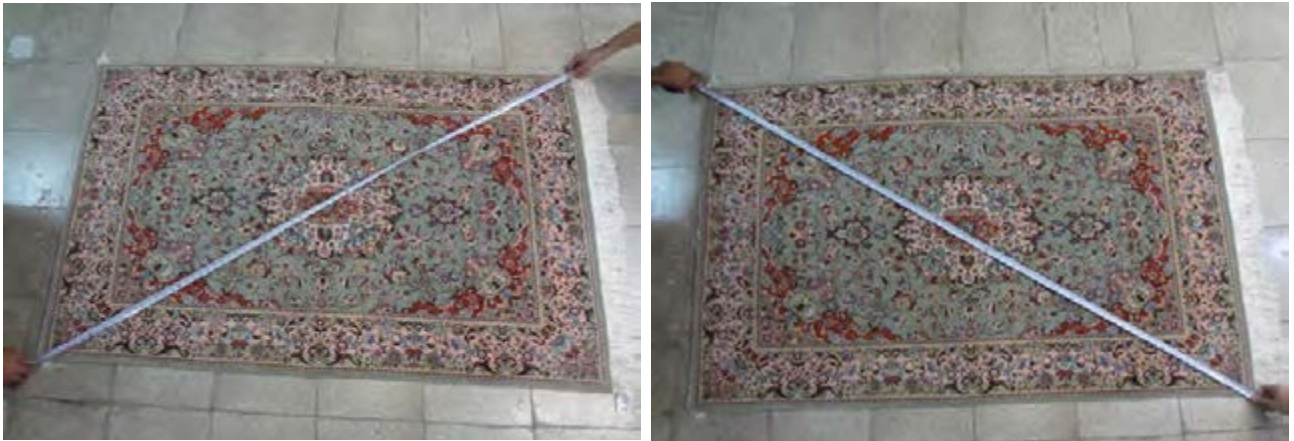
تصویر ۹- اندازه‌گیری قطرهای قالی با متر ▲
