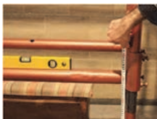
شکل ۱۹ و ۲۰- بستن اجزاء دستگاه با رعایت صحیح فواصل و موازی با افق
