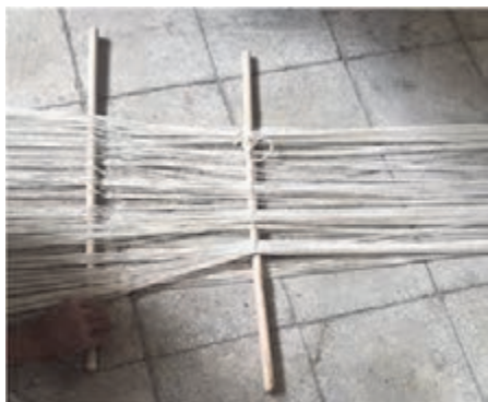
شکل ۳۷- قرار دادن چوب‌های گُرت در داخل چله
