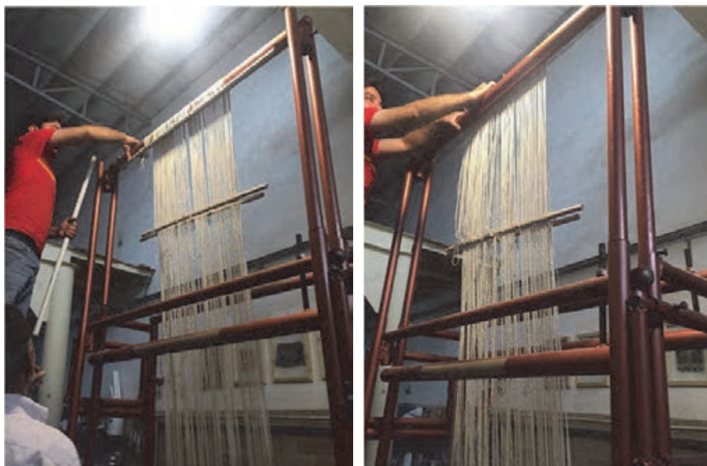
شکل ۴۳- بستن چله‌ها بر روی تیر بالا
