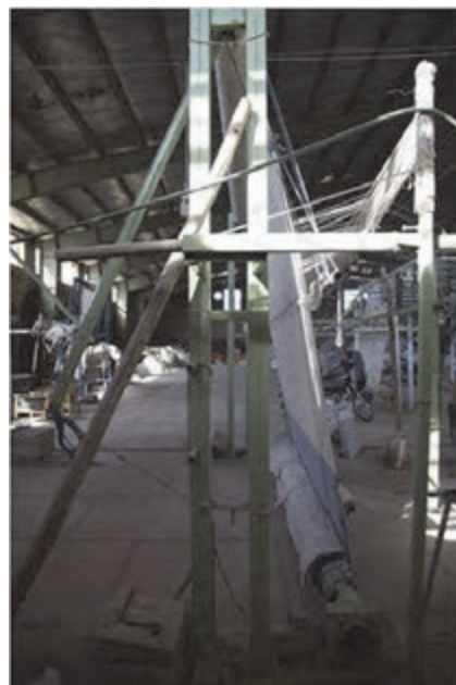
شکل ۴۸- دستگاه متحرک با اتصالات پیچ و مهره
