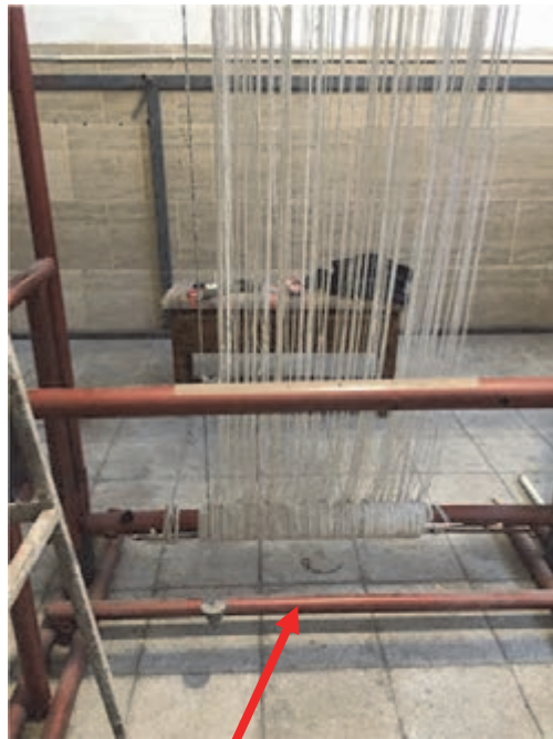
شکل ۴۴- تنظیم چله‌ها به کمک شاغول
