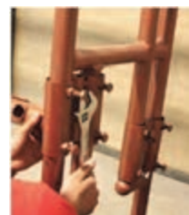
شکل ۱۸- بستن پیچ‌های قطعات دستگاه
