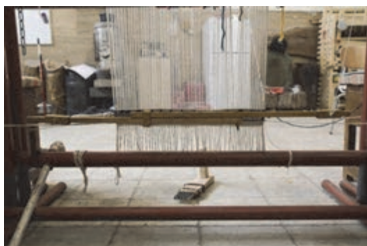
شكل ۷۷- مهيار پهناوند و بستن آن به كار
