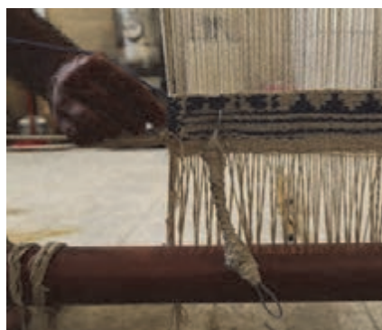
شكل ۷۶- عبور حلقه از داخل سوزن
