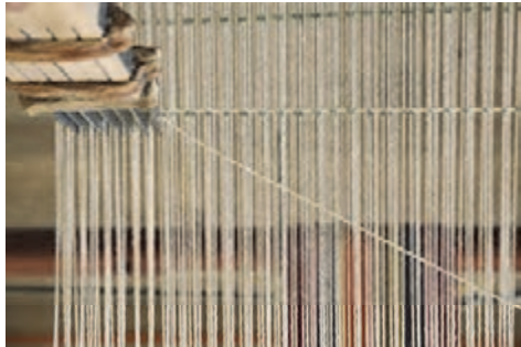
شکل ۷۱- کوبیدن پود به وسیله پنجه
