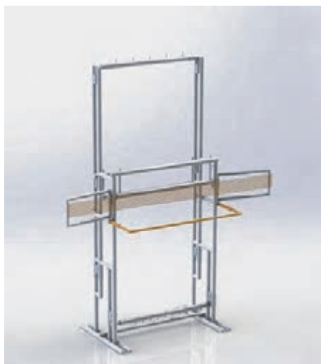
شکل ۶۵- قرار دادن میله پشت بند
