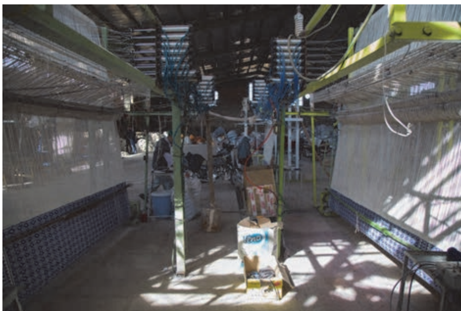
شکل ۲۷- دستگاه مکانیکی بافت زیلو
