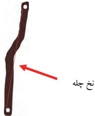
شکل ۲۸- قرارگیری زاویه چله در دستگاه زیلو
