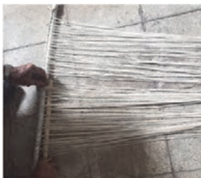
شکل ۳۷- قرار دادن چوب‌های گُرت در داخل چله
