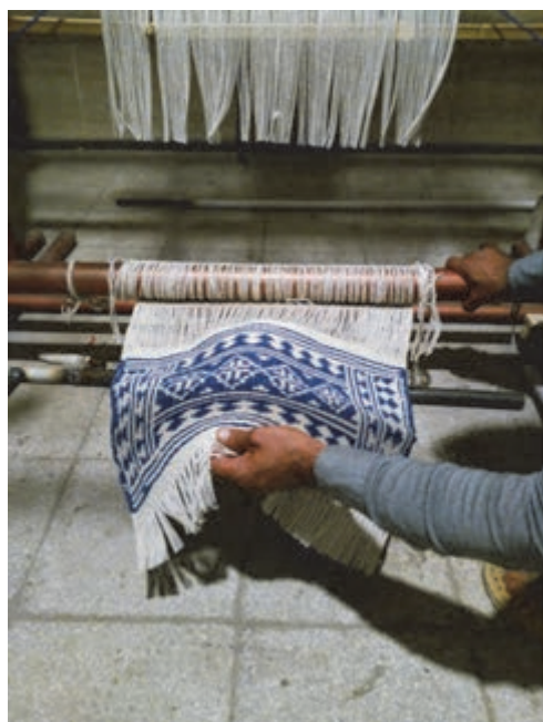
شکل ۸۵- باز کردن زیلو از روی تیر پایین
