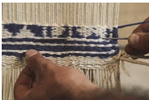
شكل ۷۵- قرار دادن سوزن مهيار در داخل بافته
