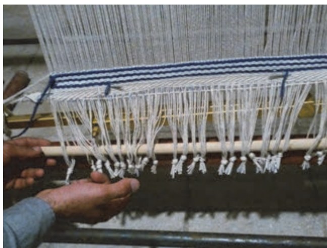
شکل ۸۹- قرار دادن چوب مهار
