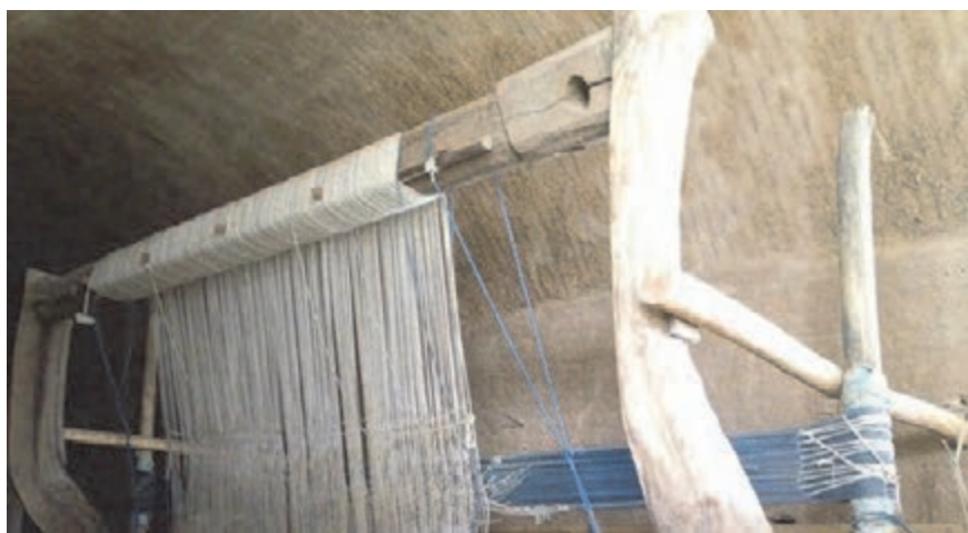
شکل ۳۰- تیر بالا در دستگاه زیلوبافی
