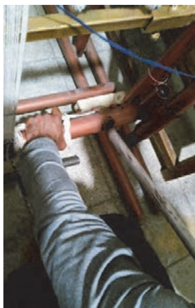
شکل ۸۴- آزاد کردن تنگ پایین دستگاه
