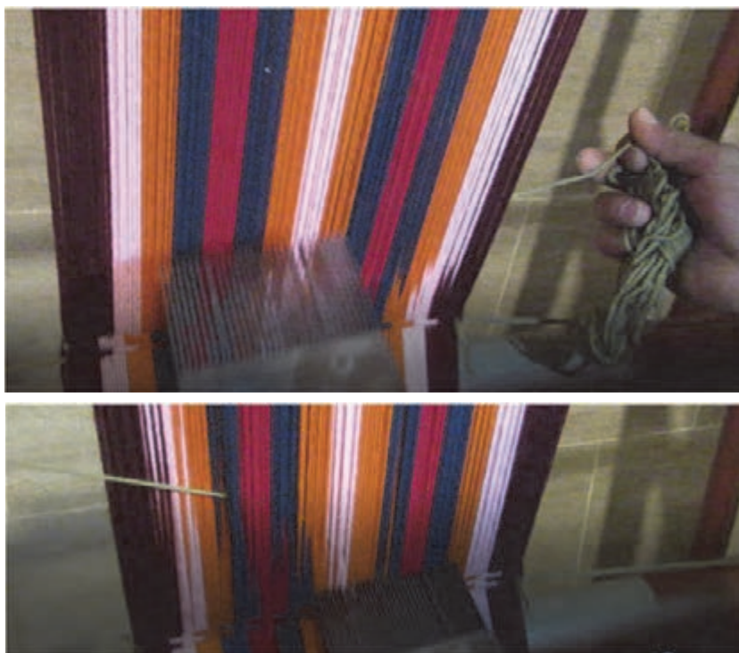
شکل ۲۲- کوبیدن پود در هنگام بافت
