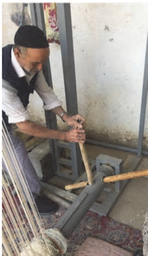
شکل ۶۶- تنظیم فشار چله‌ها
