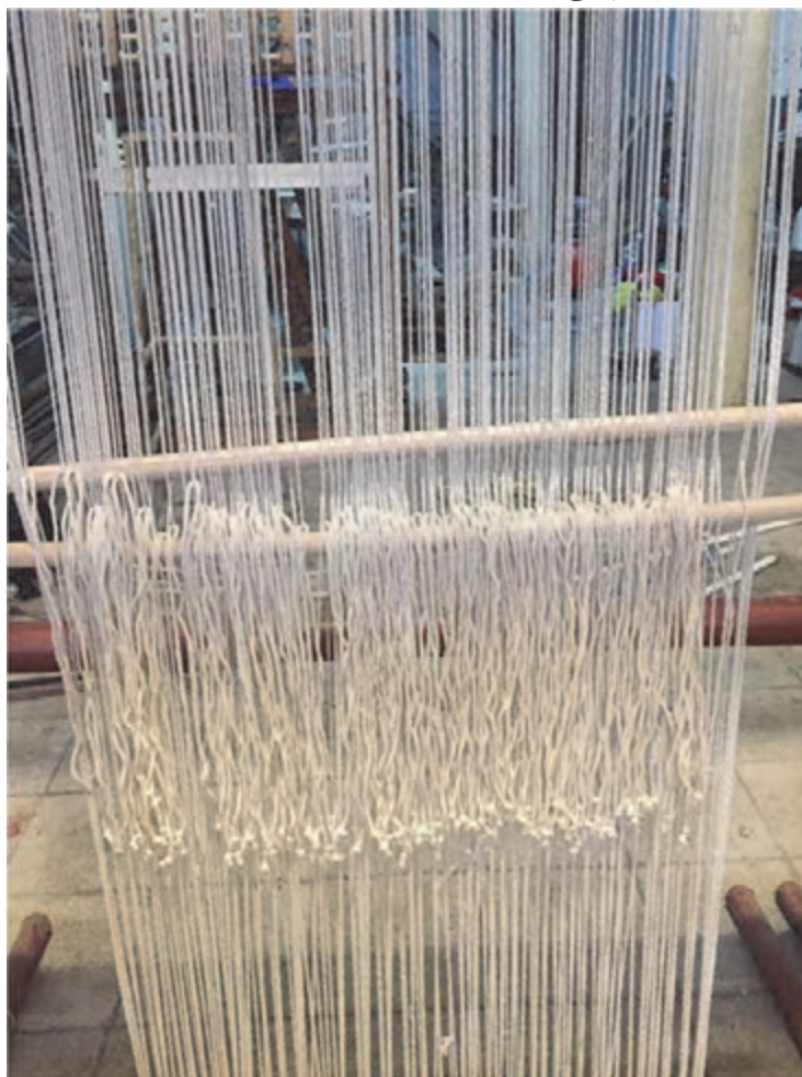
شکل ۵۴ - قرار دادن گرت‌های نقش بر روی چله‌ها
