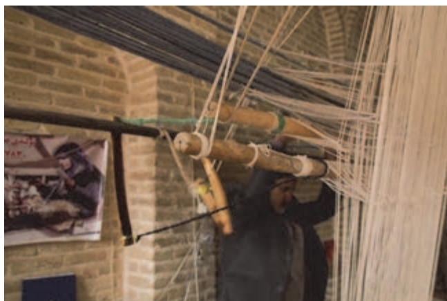
شکل ۳۳- شمشه‌ها در دستگاه زیلوبافی
