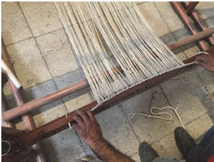
شکل ۴۱- بستن چله بر روی تیر پایین
