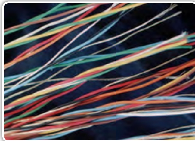
▲ شکل ۲۸-۳) رنگ‌های مختلف کابل‌های تلفن امکان تشخیص خطوط مشترک‌های متفاوت را فراهم می‌سازد.
