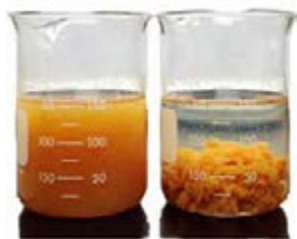
شکل ۱۱. لخته شدن کلئید در اثر افزودن محلول الکترولیت.
