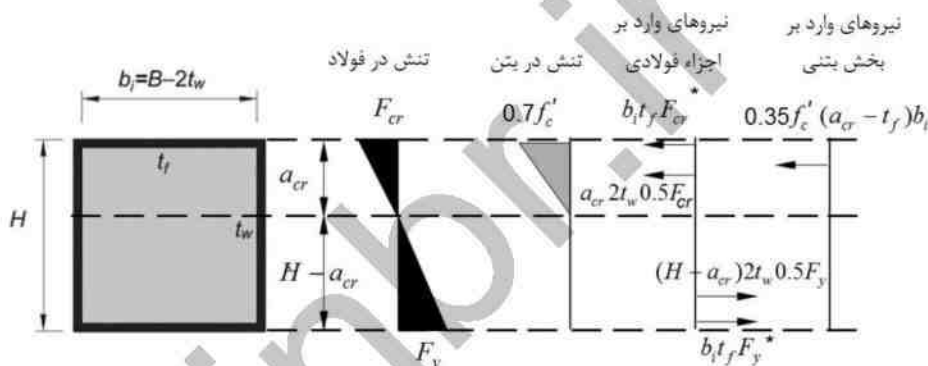
شکل ۱۰-۲-۸-۱۴: محاسبهٔ لنگر خمشی تسلیم مقطع مختلط پر شده با بتن برای مقاطع غیرفشرده
