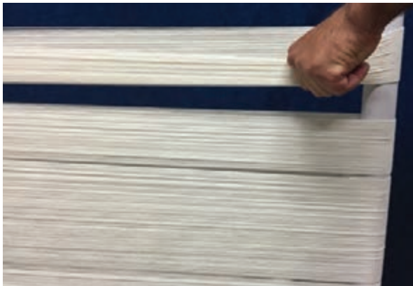
شکل ۳۰-۲- تنظیم تارها بر روی میله
