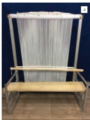
شکل ۱۹-۱- مراحل اتصال اجزای دار به یکدیگر
