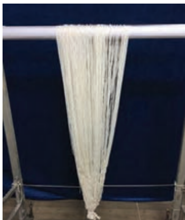
شکل ۳-۵- انتقال سردار بر روی دار بدون فندک
