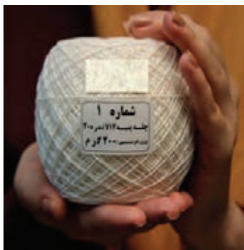
شکل ۱۶-۲- توپک ۲۰۰ گرمی، چله پنبه ای ۱۲ لا نمره ۲۰
