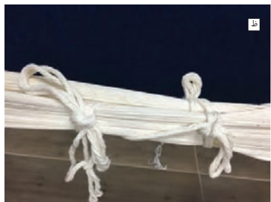
شکل ۳۵-۲- مراحل زدن نزنه بین میلیه دوم و تیرک کمکی
