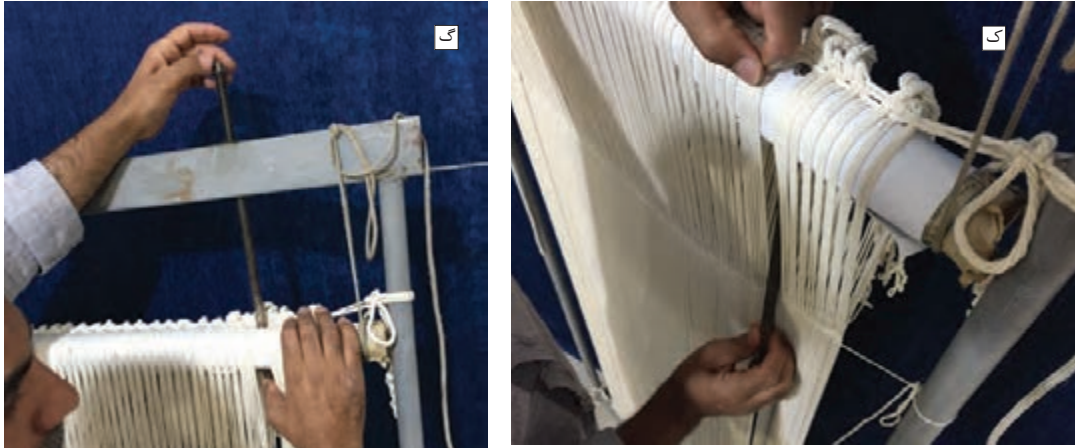
شکل ۱۳-۳- گره زدن دسته‌های چله بر روی سردار و تنظیم آنها
