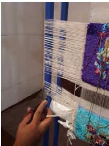
شکل ۳۴- ۵- بریدن انتهای پودها قبل از پایین کشی
