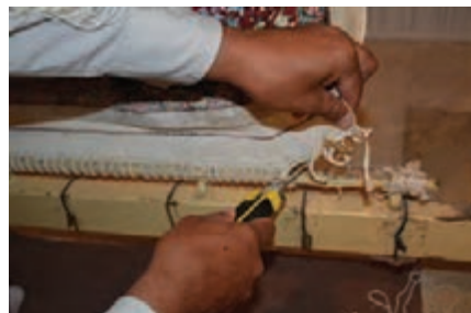
شکل ۱۳-۵ - بریدن دوخت ابتدای چله
