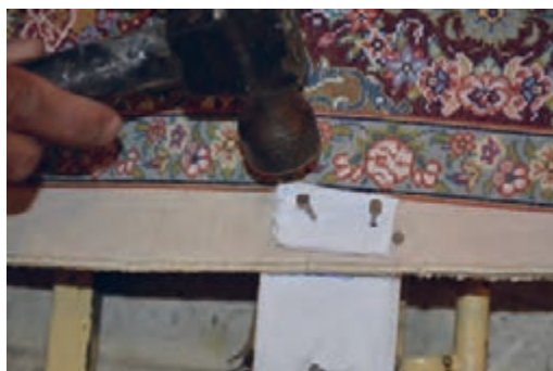
شکل ۲۴-۵ - ثابت کردن فرش با میخ
