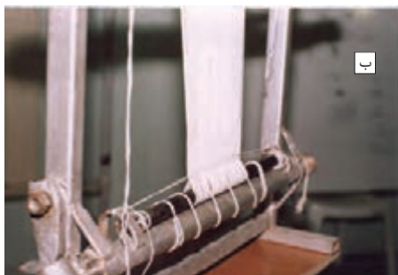
شکل ۱۱-۳- دوخت به روش میله کمکی
