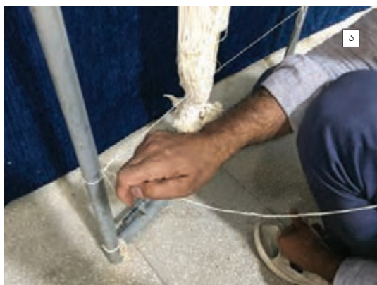
شکل ۷-۳- بازکردن نخ‌های کمکی
