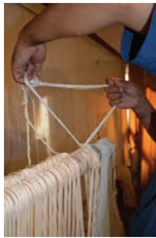
شکل ۱۱-۵ - باز کردن گره‌های سردار
