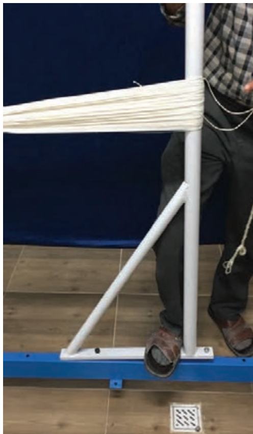
شکل ۳۸-۲- بستن انتهای چله به میله
