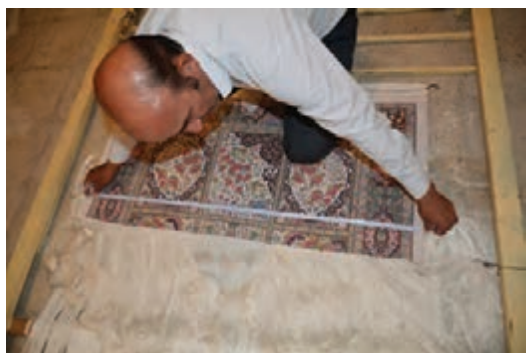
شکل ۱۹-۵ - اندازه‌گیری عرض قالی
