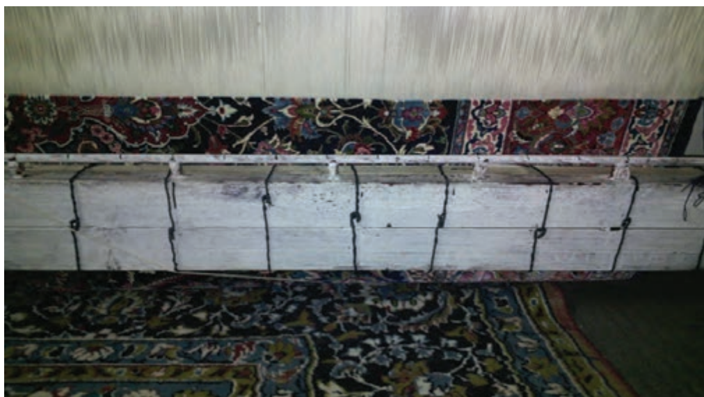
شکل ۳۲-۵ - قالی آماده برای بافت بعد از پایین کشی به روش میخ و تخته
