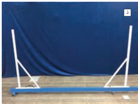
شکل ۲۷-۲- نمای کلی از دستگاه چله‌دوانی، میله‌ها، و نصب اجزای آن
