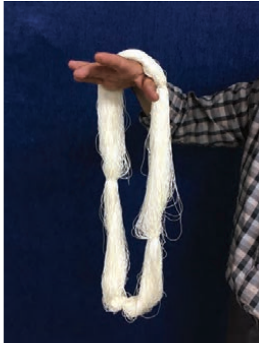
شکل ۲۲-۲- برداشتن کلاف و باز کردن تاب کلی
