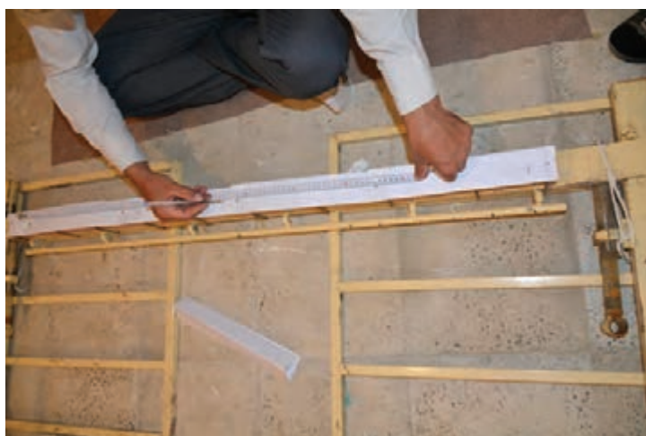
شکل ۲۳-۵ - اندازه گیری و نشانه گذاری
