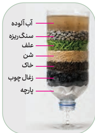
نحوه زال کردن آب (تصفیه فیزیکی)
