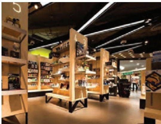
شکل ۸-۲- نمونه‌ای از قفسه‌هایی که قسمت کف زیر آنها آزاد و قابل شست‌وشو است.
