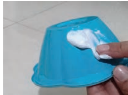
شکل ۴۳-۵- آغشته کردن مدل با ماده جداکننده (مایع ظرفشویی یا وازلین)
