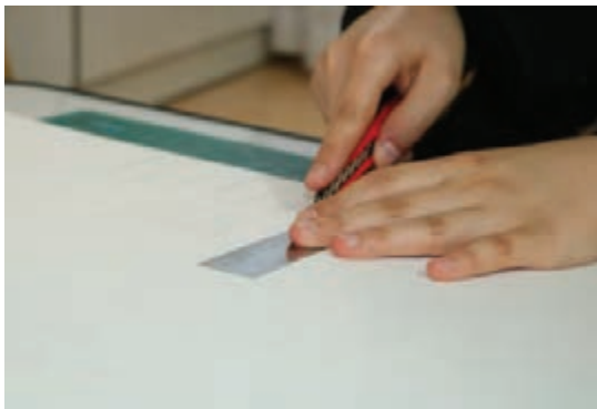
شکل ۵-۷۸- برش قطعات دیوارها و خالی کردن محل بازشوها و روزنه‌ها
