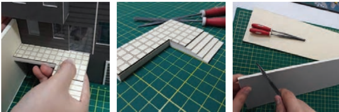
شکل ۵-۱۰۴- ساخت پله به روش قرارگیری چند لایه مقوا بر روی هم شکل ۵-۱۰۵- آماده کردن پله و ایجاد شیار جهت نمایش سنگ فرش شکل ۵-۱۰۶- نصب پله در محل ورودی
