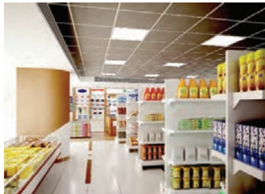
شکل ۲-۴۷- استفاده از نور طبیعی از سمت چپ و تکمیل آن با نورپردازی مصنوعی عمومی برای کل فروشگاه
