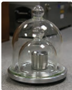
شکل ۱-۷ استاندارد ملی کیلوگرم که نسخه دقیق‌تری از استاندارد بین‌المللی سور فرانسه است. این نمونه، در مرکز اندازه‌شناسی در سازمان ملی استاندارد ایران نگهداری می‌شود.
