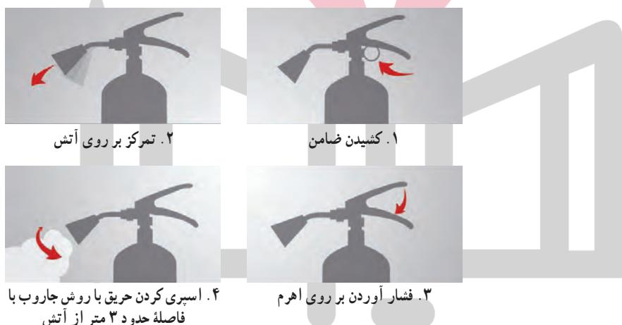
شکل ۶. نحوه استفاده از کپسول اطفای حریق
