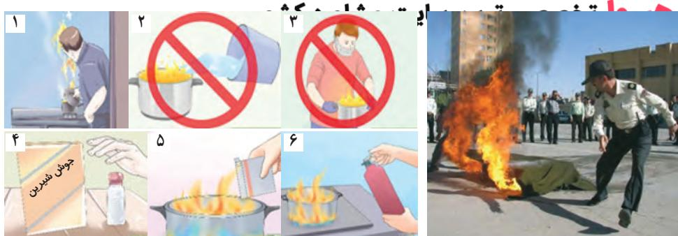
شکل ۵. خاموش کردن آتش سوزی مایعات قابل اشتعال
