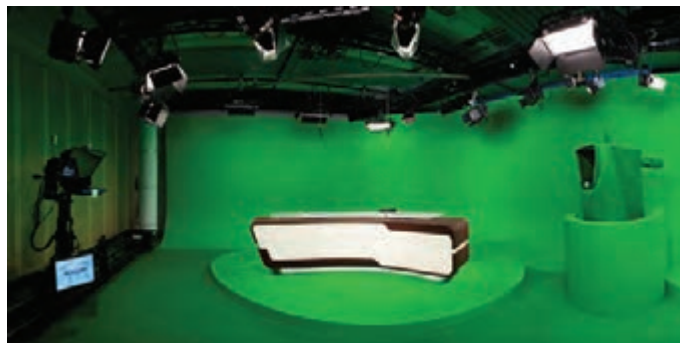
تصویر ۲۴- تمام قطعات داخل دکور با رنگ سبز پوشیده شده، برای امکان ایجاد تصاویر در همه نقاط صحنه استودیو مجازی
