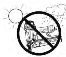
شکل ۱۰۷- محافظت شیلنگ هوا از بارش برف و باران و تابش خورشید
