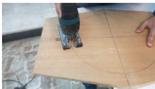
شکل ۶۱- برش کفی دایره شکل
