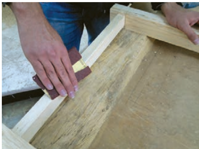
شکل ۶۰- سنباده زدن و گرفتن تیزی لبه‌ها
