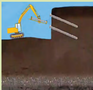
پایدارسازی شیب به روش میخ کوبی
