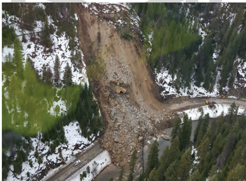
شکل ۹-۴- زمین لغزش در یک جاده
