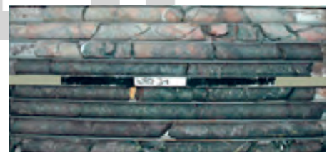
الف) مغزه گیری با گمانه های اکتشافی
