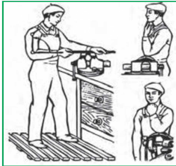
شکل ۱۶-۱- روش صحیح ایستادن و ارتفاع مناسب گیره
