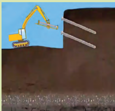
پایدارسازی شیب به روش میخ کوبی
