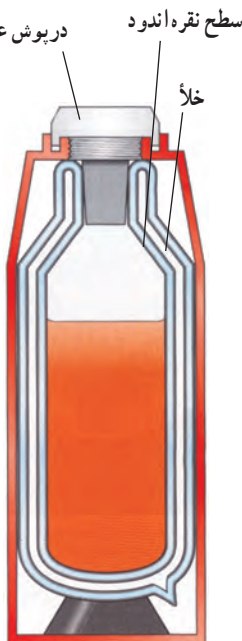
شکل ۱۳- دما بان (فلاسک) خلأ می‌تواند مدت نسبتاً زیادی دمای جسم را تقریباً ثابت نگه دارد.
