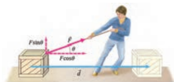
شکل ۳-۳ نیروی ثابت \vec{F} با جابه‌جایی \vec{d} زاویه \theta می‌سازد و کار W = (F \cos \theta) d را روی جسم انجام می‌دهد.
