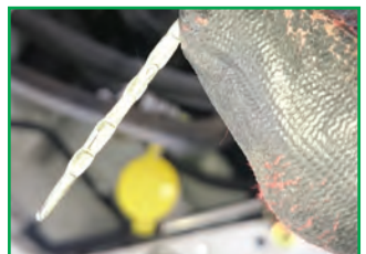
ث- میله اندازه‌گیر روغن موتور را مجدداً ج- در صورت کم بودن روغن موتور، ج- به مقدار مورد نیاز، روغن به موتور بیرون کشیده و با توجه به شاخص روی درپوش مخزن روغن موتور را باز کنید. اضافه کنید. میله، مقدار روغن موتور را کنترل کنید.
