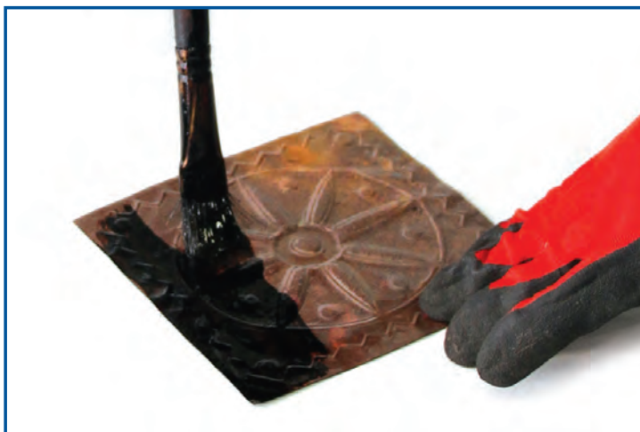
شکل ۱۰-۱- آغشته کردن سطح پلاک مسی به قیر
