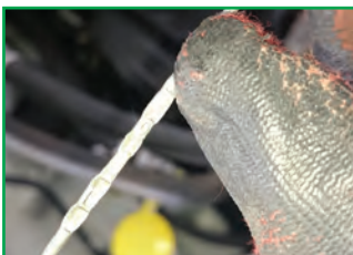
ح- میله اندازه‌گیر روغن موتور را مجدداً کنترل کنید.
