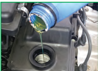
ج- به مقدار مورد نیاز، روغن به موتور
