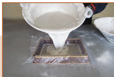
ث - ریختن ملات گچ در قالب
