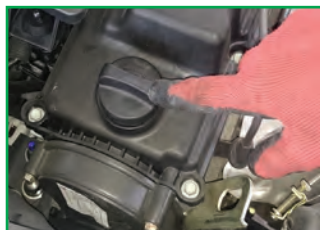
ث- میله اندازه‌گیر روغن موتور را مجدداً ج- در صورت کم بودن روغن موتور، ج- به مقدار مورد نیاز، روغن به موتور بیرون کشیده و با توجه به شاخص روی درپوش مخزن روغن موتور را باز کنید. اضافه کنید. میله، مقدار روغن موتور را کنترل کنید.
