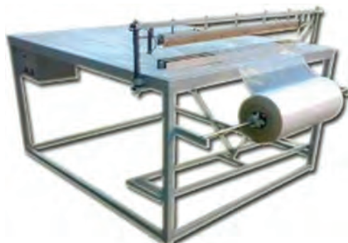
شکل ۲۰-۱۱- دستگاه بسته بندی اولیه حبوبات
