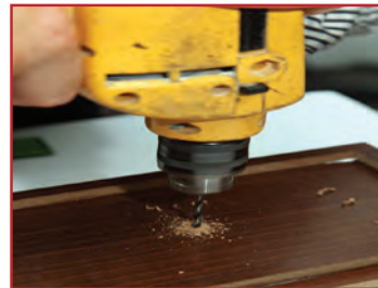
پ- سوراخ کردن در جعبه با دریل
