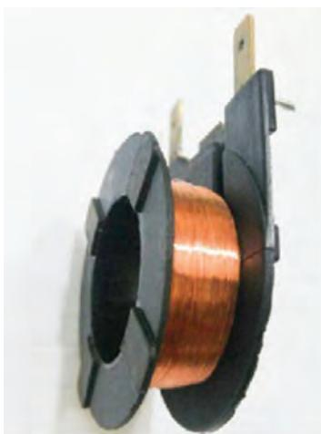
شکل ۲- سیم پیچ داخل موتور
