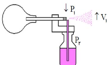
با فشردن مخزن هوا یا اهرم، جریان سریع در بالای لوله فرو رفته در مایع، ایجاد و سبب کاهش فشار هوای بالای لوله می شود. بنابراین شاره در لوله بالا آمده و با جریان هوا مخلوط و از طریق روزنه به بیرون پاشیده می شود.
